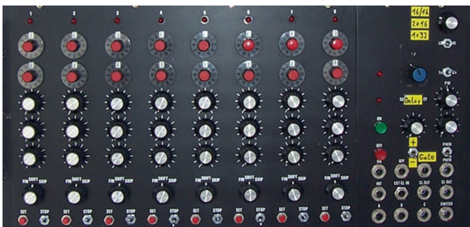
Abbildung 4: Schritt-Sequenzler mit Taktgeber, Spannungs- und Impulsausgänge - Einheit unten
